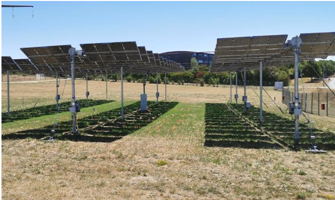
Effet des panneaux photovoltaïques sur la réduction de l'évapotranspiration du sol et des plantes pendant une période de sécheresse (Source : EDF R&D, site expérimentale Les Renardières)
