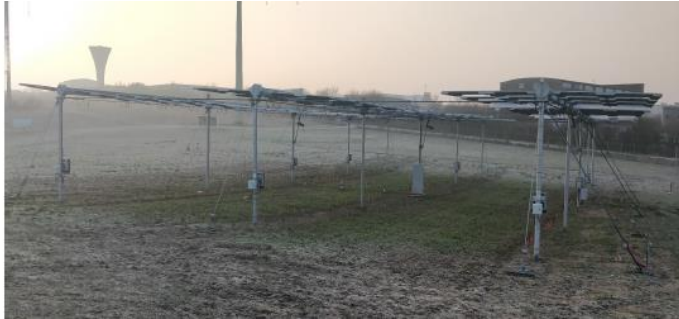
Effet des panneaux photovoltaïques sur la réduction d'un épisode de gel (Source : EDF R&D, site expérimentale Les Renardières)
